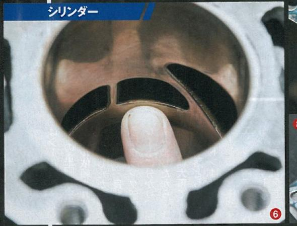
⑥ニカジルめっき処理されたシリンダー内壁は、排気ポート(指示部)や掃気ポート(逆側)のエッジを確認、バリがあれば滑らかにしたい。バリが内部に落ち込んで回ることでのトラブルを防ぐためだ
