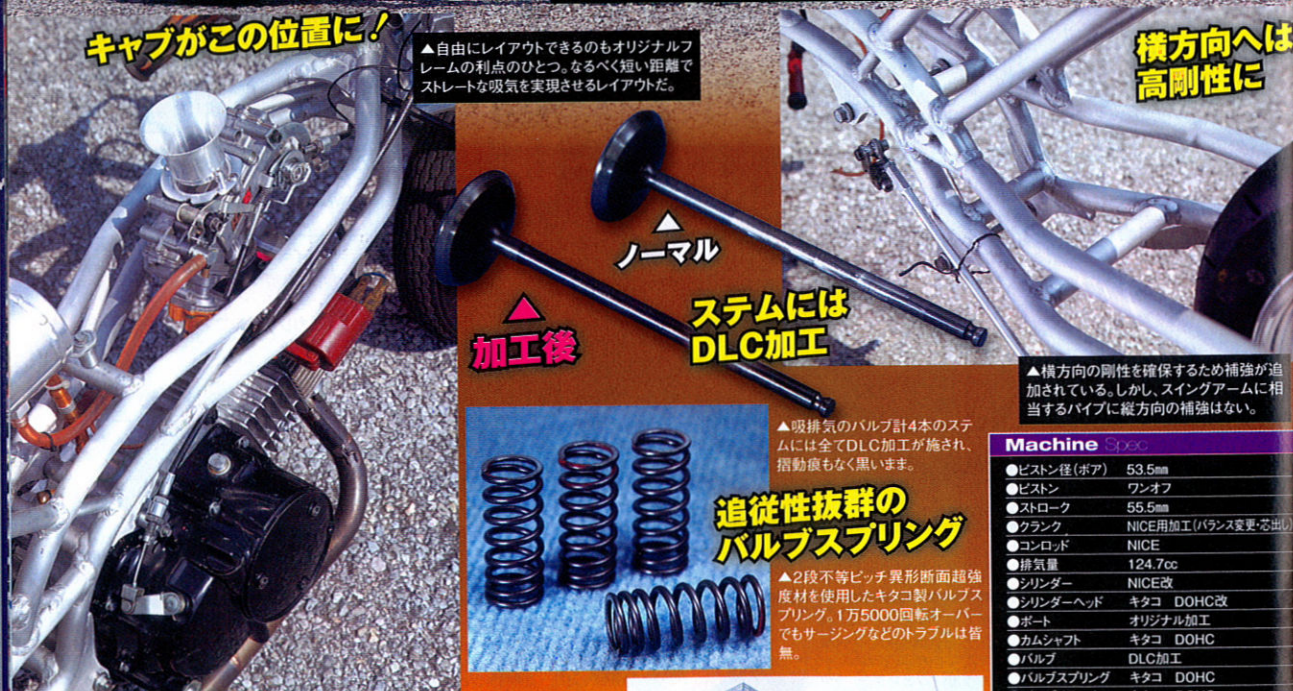
▲このマシンの最大のポイントがこのフレーム。縦方向に微妙なしなりを持たせ、トラクションの確保に貢献。
